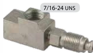
BQ378 Swivel Tee M10 × 1 port 7/16-24 UNS port M10 × 1 tube nut, DIN flare
